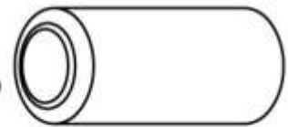
"Compound"-Schweißkante mit zwei Winkel (verschiedene Winkel können kombiniert werden)
