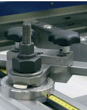
Verlängerter Winkelanschlag mit Gradeinteilung von 0° - 360°
