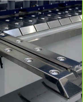
Verschiebbare Tischverlängerung auf Führungsschiene montiert
