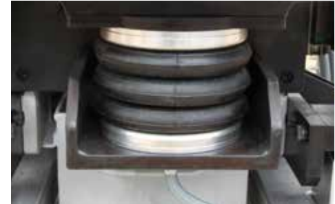
Système pneumatique pour fixer le matériau. Pneumatisches System zum Fixieren der Platte
