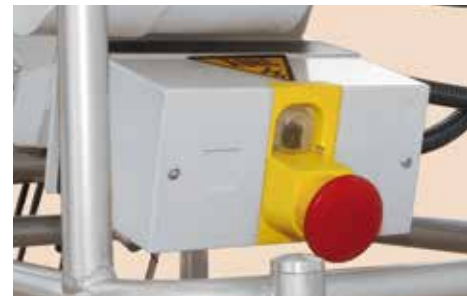
Boîte électrique accessible. Zugänglicher Schaltkasten.
