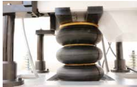
Système pneumatique pour régler la hauteur du travail. Pneumatisches System zum Einstellen der Arbeitshöhe.
