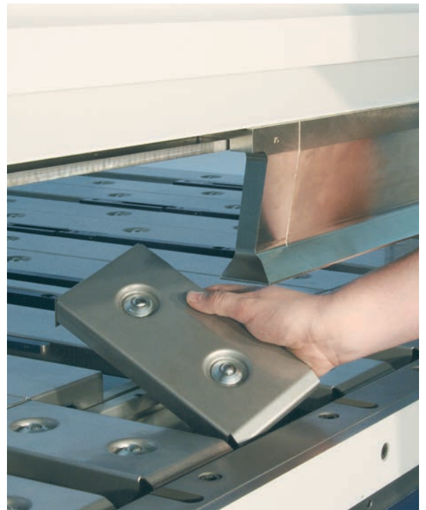
Herausnehmbare Auflagebleche, rückziehbar auf 337 mm.
