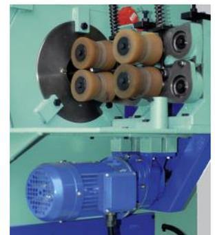
Selbstzentrierende vordere und hintere motorisierte Vorschub mit der Einstellung der Geschwindigkeit
