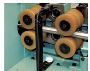
AN/A Zubehörteil für Schleifbändereröffnung mit Fotozelle und PLC
