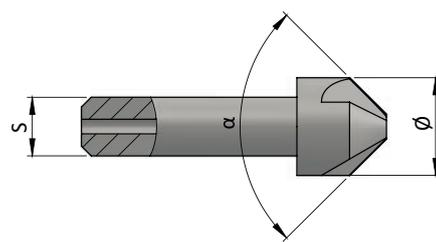
\* Erklärung der Kürzel:  $\alpha$  = Spitzenwinkel, S = Schaftdurchmesser, Z = Zähnezahl, FL = Führungslineal, FZ = Führungszapfen
