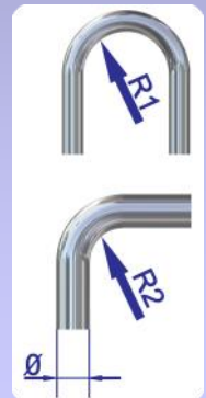
R1 min. = 80 mm R2 min. = Rohr Ø
