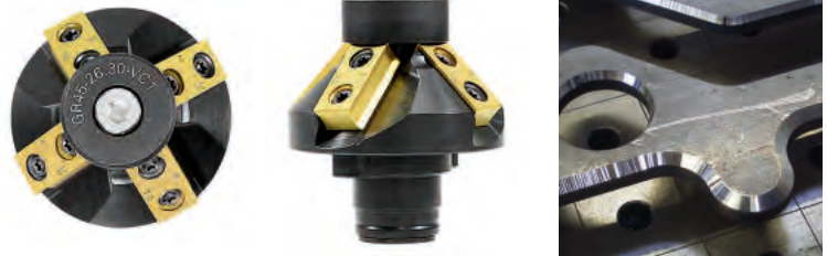
Abb. 45°-Fasen-Fräser mit 4 Schneiden und Führungsrolle, bestückt mit 4 Fasen-Wendeschneidplatten vom Typ D
