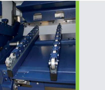
Blechhochhaltevorrichtung pneumatisch gesteuert
