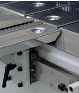
Verschiebbare Tischverlängerung auf Führungsschiene montiert
